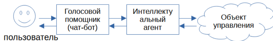
Рис.1. Концептуальная модель автоматизированной системы управления
