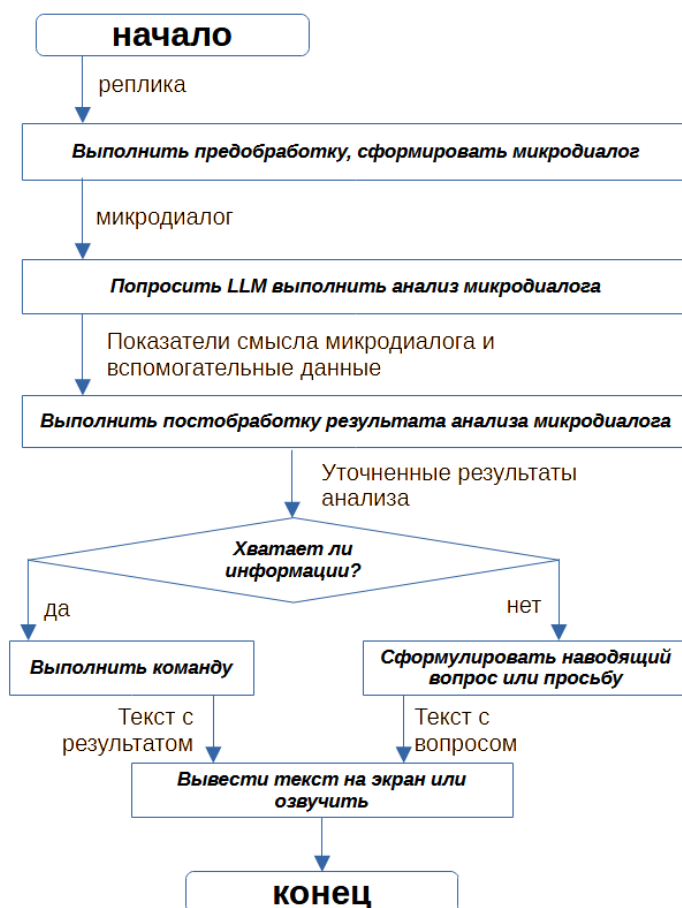
Рис. 4. Алгоритм определения потребности пользователя
