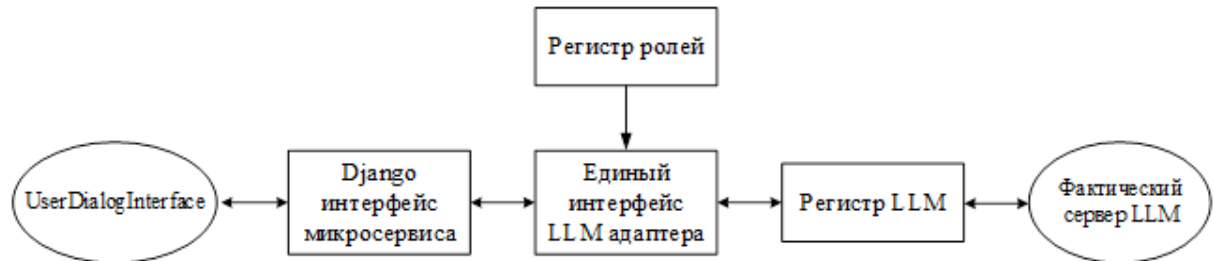
Рис. 5. Структура элемента AIAdapter
